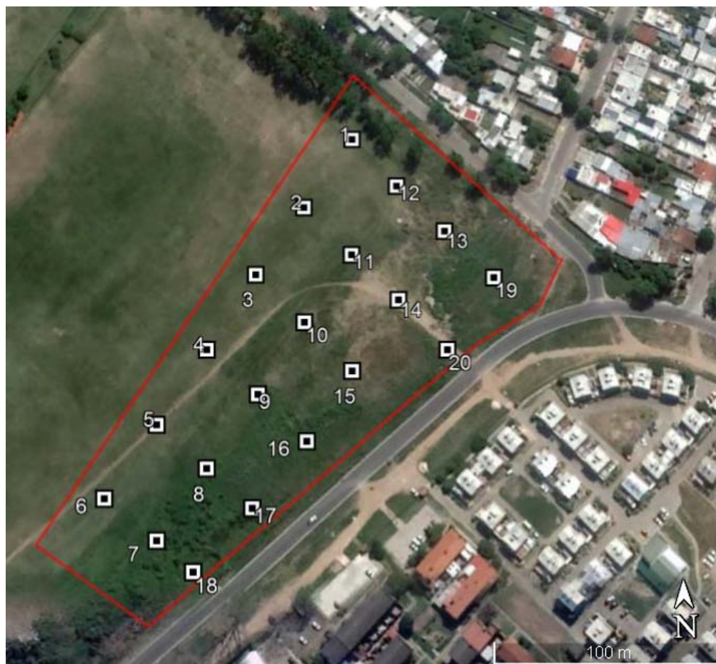
Figura 2. Ubicación de las perforaciones realizadas
