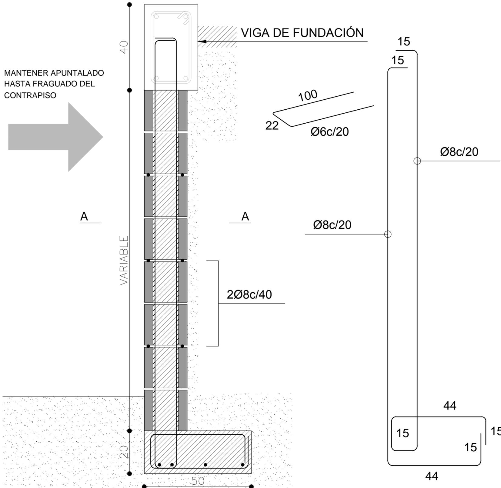
Muro de contención esc.:1/10
