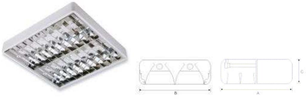
Luminaria de adosar, 3 2G11 36W, cantos redondeados. Chasis realizado de acero, lacado en epoxi-poliéster blanco. Doble louver parabólico de aluminio alta pureza y abrigantado, sujeto al chasis por medio de cuatro resortes internos que permiten el abatimineto lateral de la óptica, con equipo Tridonic 230V, corrección de factor de potencia, y lámparas PL-L 36W/830 Philips.IP 20Medidas: A 525 B 525 C 90Modelo: (DPB336A) LuxacrilParaguay\_Austria
