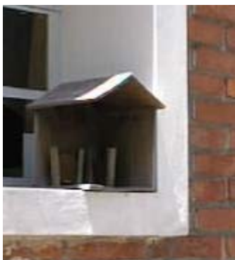
Figura 6: Caseta de muestreo para la determinación del índice de corrosividad conteniendo los discos de acero SAE 1010 oxidable (LHA).
