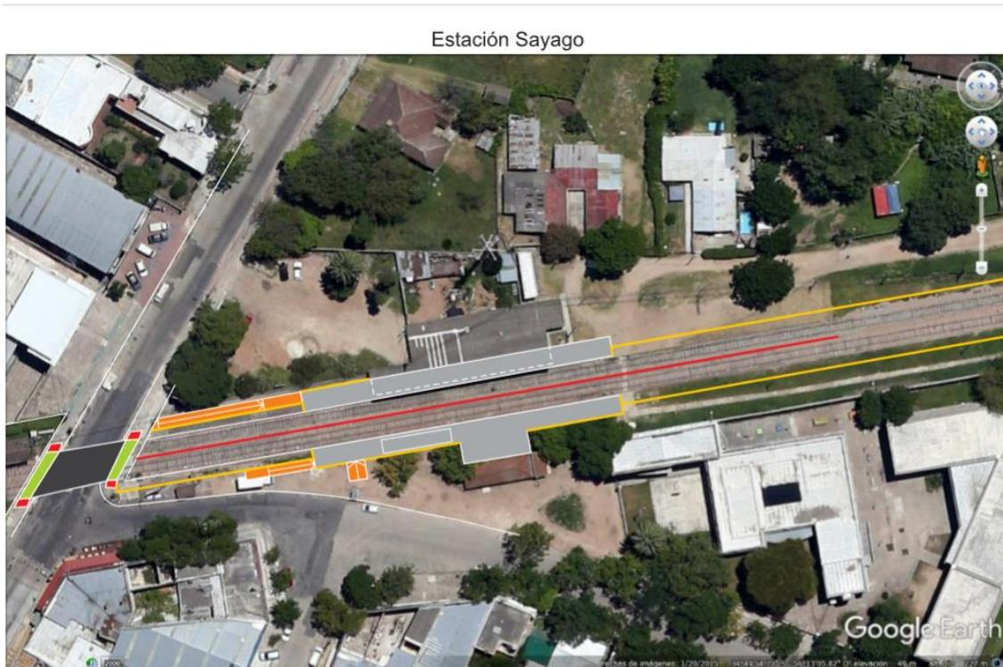
Esquema sobre foto aérea de Estación Zayago en donde se muestra el cruce a nivel en Cano. Ariel. La línea roja entre las dos vías férreas representa un tejido metálico de 1,80mts de alto dispuesto con el objetivo de evitar cruces no deseados entre andenes. El flujo peatonal se encauza hacia el paso a nivel en Cano. Ariel que dispone de todas las medidas de seguridad necesarias.
