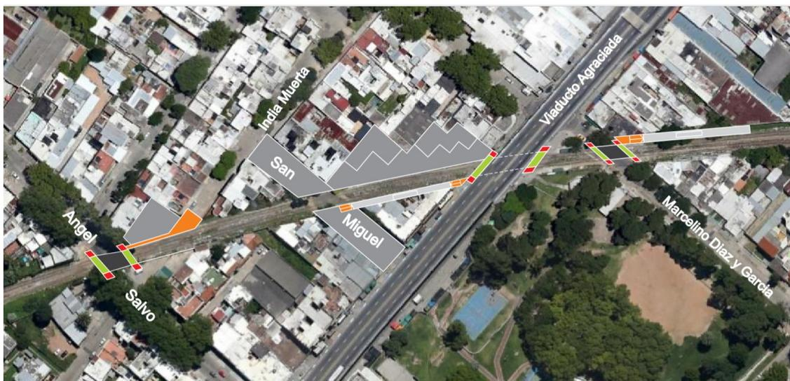
El esquema sobre la foto aérea muestra la distribución de andenes de entrada y salida en Parada Agraciada y la resolución de pasos a nivel en Angel Salvo y Avda. Agraciada.
