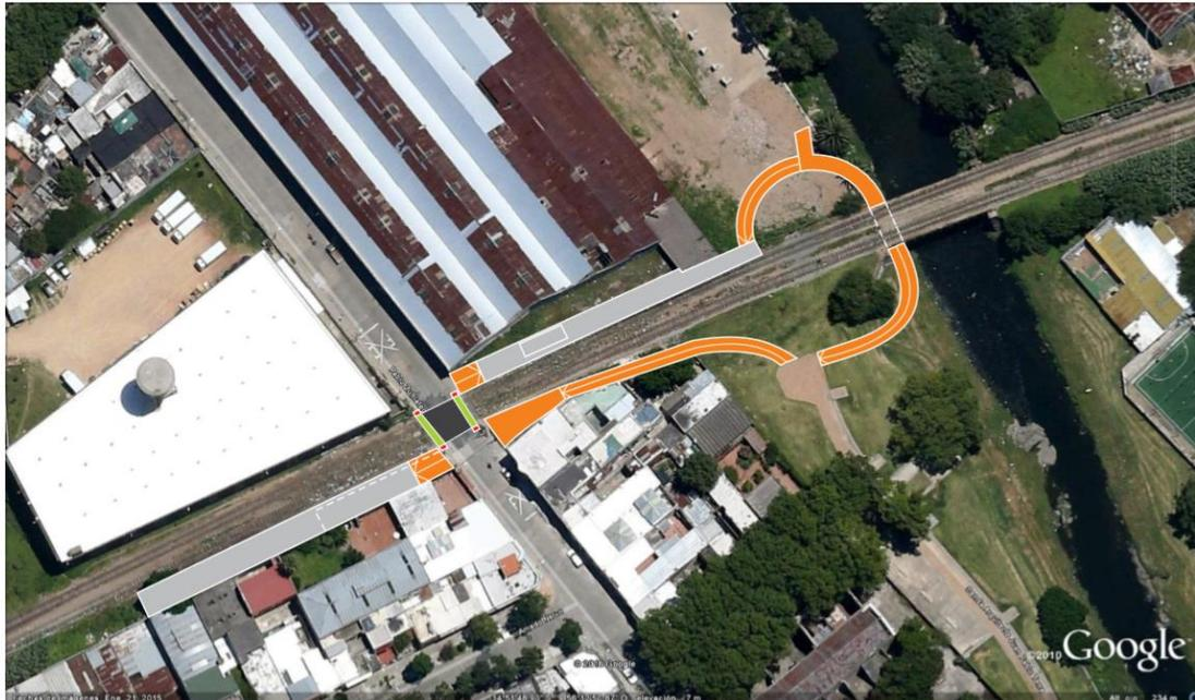
El esquema sobre foto aérea muestra los caminos peatonales de conexión del parque lineal por debajo del puente ferroviario y la conexión con los andenes de la parada Yatay.
